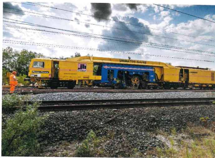
Bild 6: Stopfmaschine im Einsatz
